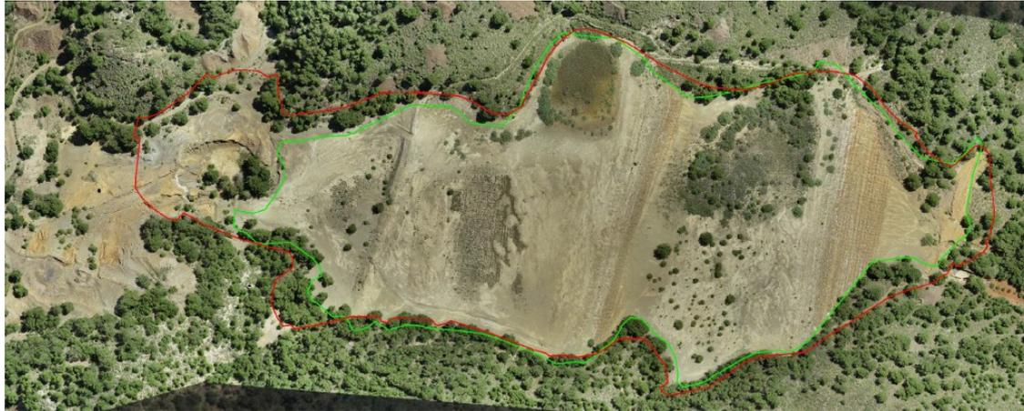
En la figura anterior se puede observar la superficie definida en el proyecto inicial (línea verde) con una medición de 74.711,69 m<sup>2</sup> y la superficie sobre la que realmente se ha actuado en el depósito de lodos (línea roja), con una medición de 89.762,00 m<sup>2</sup>.
