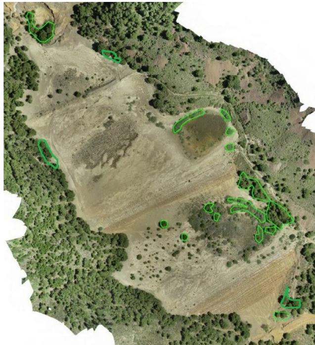
La siguiente unidad de obra comprende los *trabajos de relleno y adecuación de zonas deprimidas*. Los trabajos se corresponden con la regularización, relleno, distribución y compactación de lodos. Esta secuencia permitirá alcanzar una conformación geométrica estable de la estructura geométrica del depósito de lodos. Esta nueva geometría es la base
