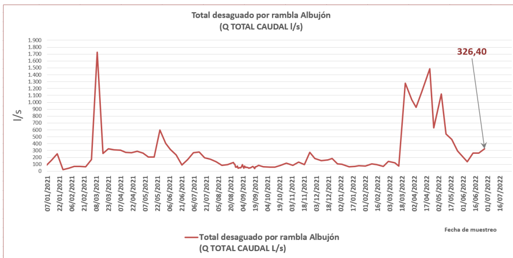
Gr1fica 3- Evoluci3n del volumen total desaguado por la rambla del Albuji3n desde a1o 2021.
