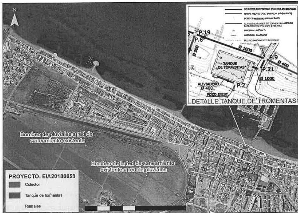
Figura 6.- Infraestructuras proyectadas en el Proyecto "Colectores y Tanque de Tormentas en Los Nietos." (EIA20180058), sobre ortofoto PNOA'16. Fuente: Proyecto Técnico aportado por la D. G. del Agua.
