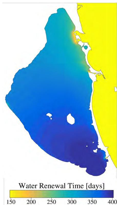
Figura 94. Tiempo de renovación de agua en el Mar Menor promediado verticalmente en el escenario sin perturbaciones.
