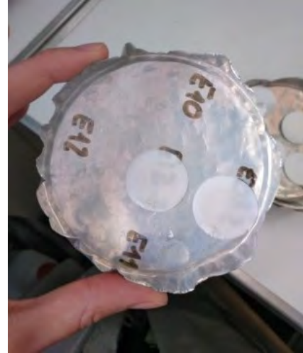
Figura 13. Rampa de filtrado y filtros para la determinación de los materiales en suspensión.
