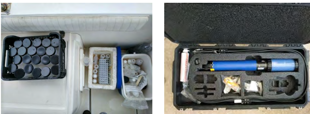
Figura 12. Materiales y equipos (sonda multiparamétrica YSI EXO2) empleados en las campañas para la toma de datos y muestras en la columna de agua.
